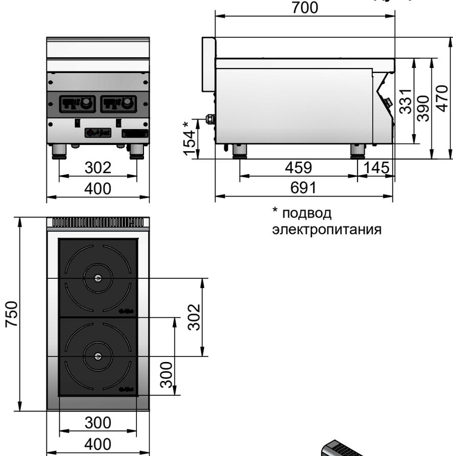
Плита индукционная кухонная настольная **КИП-27Н-3,5** предназначена для приготовления первых, вторых и третьих блюд в специальной наплитной посуде.
